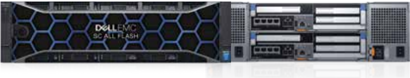
인텔® 제온® 프로세서 기반 SC5020F 컨트롤러(전면) 전면 / 후면( 1 x PCIe FH)
